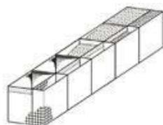
Constitués comme le gaburgence, ces modules en partie doublés d'un géotextile, sont compartimentés sur leur face vue, pour permettre d'avoir un parement de 30 cm de pierres. Ils peuvent ainsi être remplis à l'arrière de matériaux de qualité médiocre ou de déchets inertes et les belles pierres sont réservées pour l'appareillage du parement.
