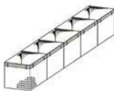
Construite en panneaux électrosoudés revêtu de **GalFan®** reliés entre eux par des spirales rigides (qui font charnières), ces structures multicellulaires sont faciles à mettre en œuvre. Les cellules sont doublées à l'intérieur d'un géotextile non tissé ou d'une membrane imperméable, ce qui permet leur remplissage avec tous types de matériaux pulvérulents (sables, terres et graviers).
