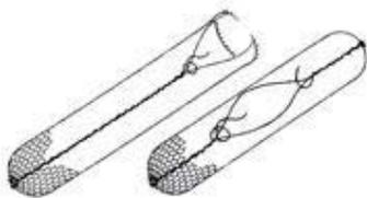
Poches de grillages métalliques de 2 ou 3 m de long et de 0.65 ou 0.85 m de diamètre. Ces gabions sacs sont aussi disponibles en synthétiques, plus souples et avec une longueur de 2 m et un diamètre de 0.30 ou 0.40 m.
